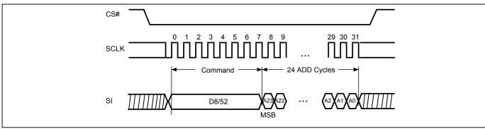
Figure 27. Chip Erase (CE) Sequence (Command 60 or C7)
